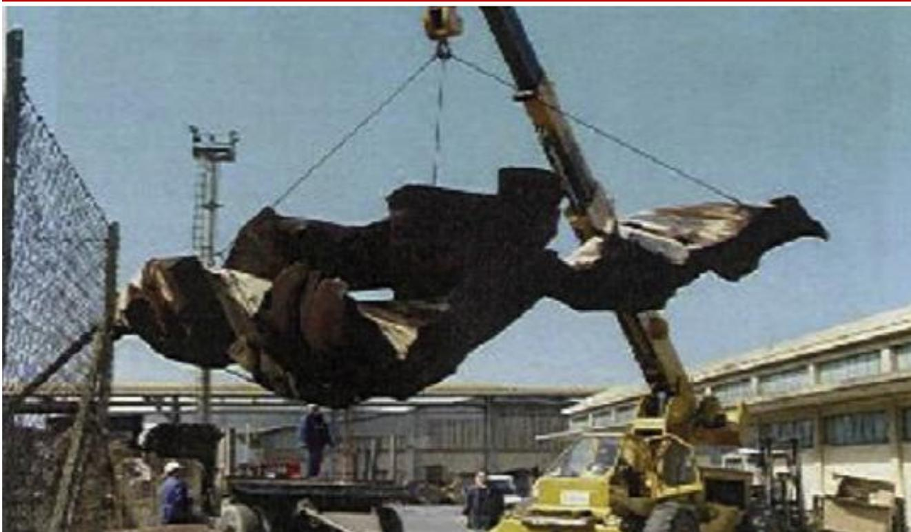
*Figura III.10. Cuerpo de un recipiente cilíndrico; 3860kg de masa, tamaño aproximado de 10000x6000 con un espesor de 9mm, (Tugnoli et al., 2014)*
