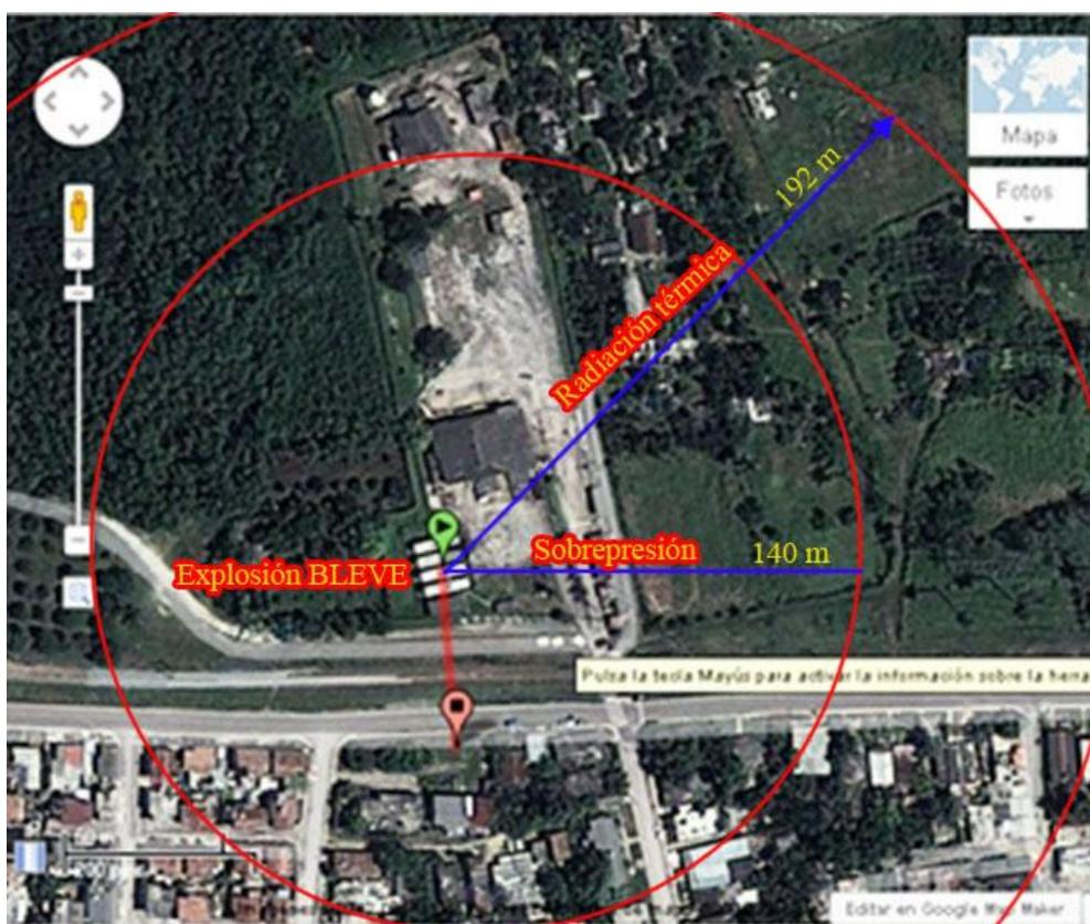
*Figura 3.13.* Perfil de riesgo del efecto dominó, se representa la afectación para los umbrales correspondientes de radiación térmica de las bolas de fuego y la sobrepresión generadas por la explosión BLEVE
