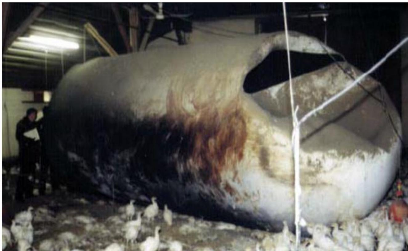
*Figura III. 7. Fragmento de un recipiente que destruye la nave de la figura IV.6 en una granja en Albert City (Iowa) en 1998. (Díaz, 2006)*
