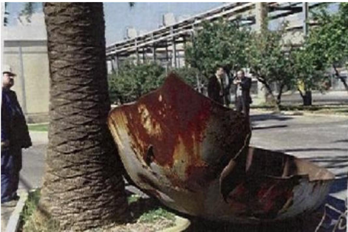
*Figura III.11. Tapa de un recipiente cilíndrico; 970kg de masa, 3200mm de diámetro y 9 mm de espesor, (Tugnoli et al., 2014)*
