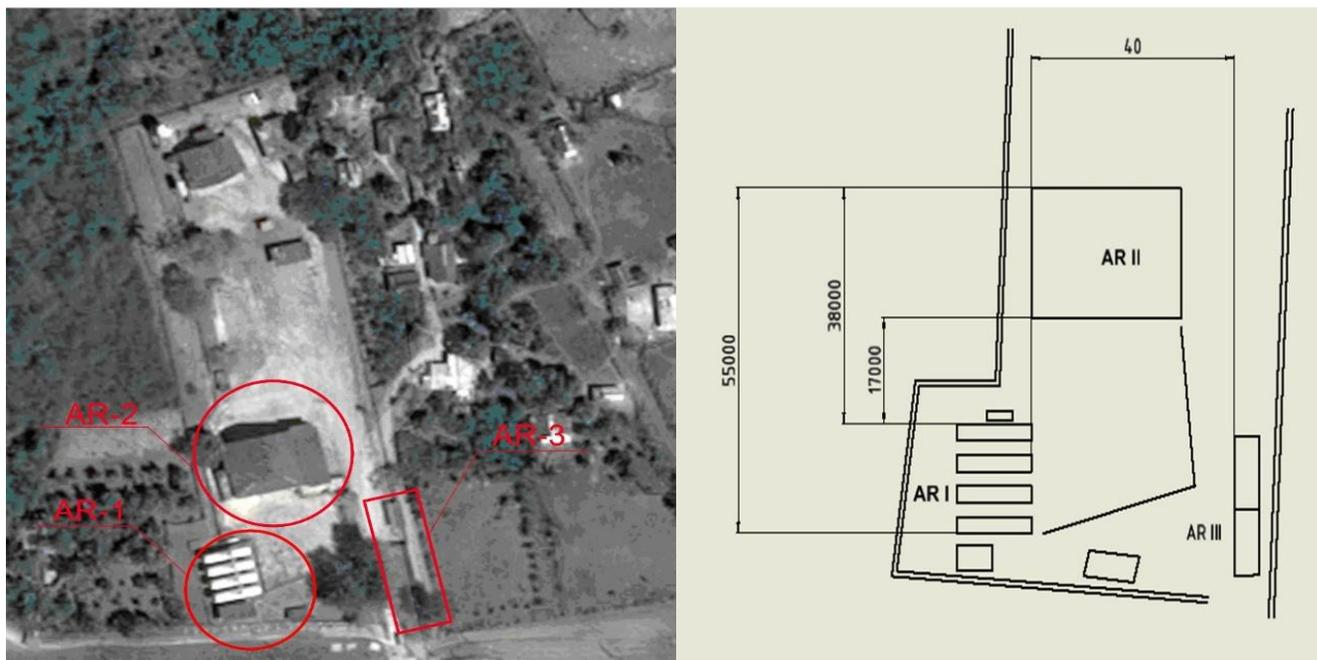
*Figura 3.2.* (a) Foto del Almacén tecnológico de GLP. (b) Esquema con las distancia entre las AR en estudio
