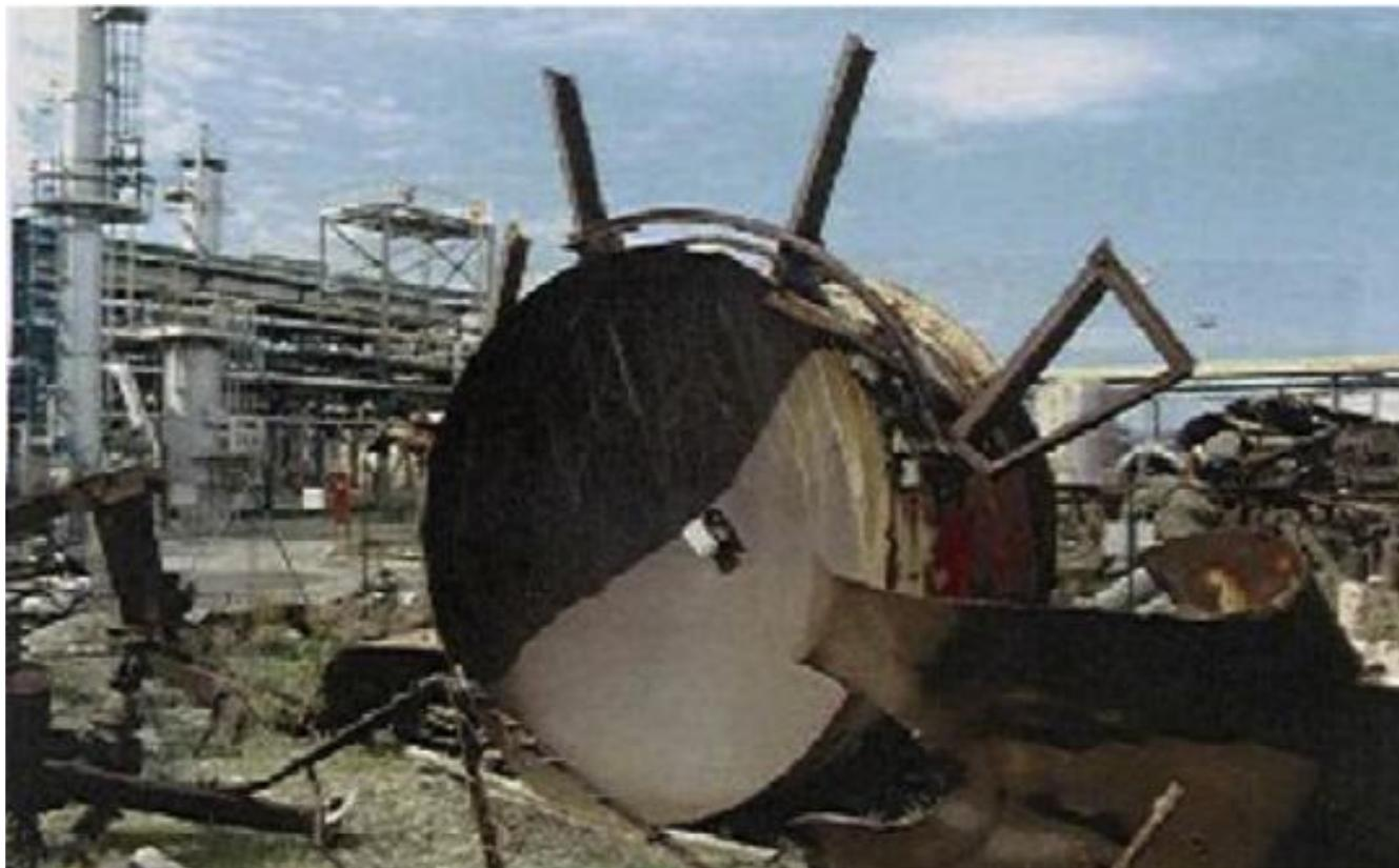
*Figura III.9. Fondo de un recipiente cilíndrico; 1000kg de masa, 3200mm de diámetro y 9 mm de espesor (Tugnoli et al., 2014)*
