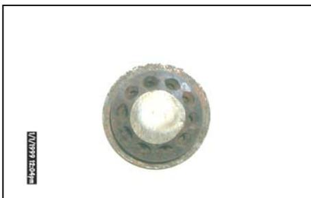
Foto – 11. Boquilla de atomización con vapor tipo Y perteneciente a la fabrica de Fertilizantes de Cienfuegos.
