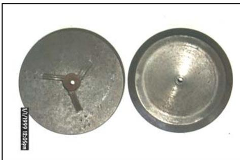
Foto – 9 Boquilla de atomización mecánica perteneciente a la caldera japonesa de la textilera Desembarco del Granma. Se aplica solamente para la arrancada.
