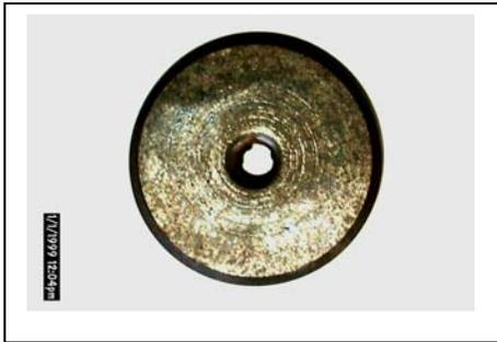
Foto – 7 Boquilla de quemador de los hornos de la fábrica de Cemento de Cienfuegos.
