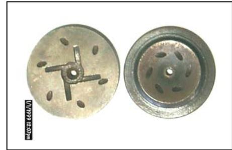
Foto- 2. Boquilla de atomización con vapor del tipo Babcock and Wilcox perteneciente a la Cervecería de Manacas.
