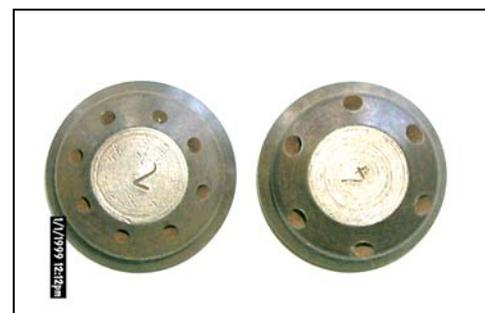
Foto - 8 Boquillas de atomización con vapor tipo Y pertenecientes a la Textilera Desembarco del Granma.
