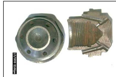
Foto - 4 Boquilla de atomización con vapor tipo Y perteneciente a la Termoeléctrica Carlos Manuel de Céspedes de Cienfuegos.
