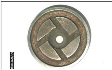
Foto - 3 B oquilla de atomización mecánica perteneciente a la Termoeléctrica de Nuevitas.
