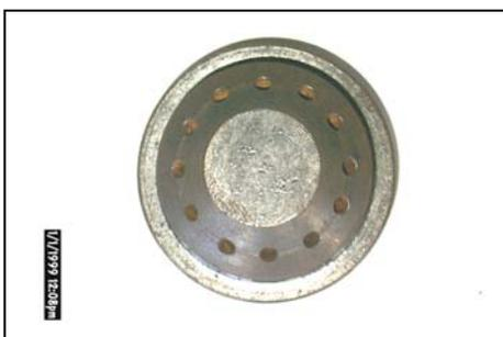
Foto - 5 Boquilla de atomización fabricada para la caldera Española del Central Quintín Banderas. Otro grupo de este mismo modelo se fabricó para el Central George Washington.
