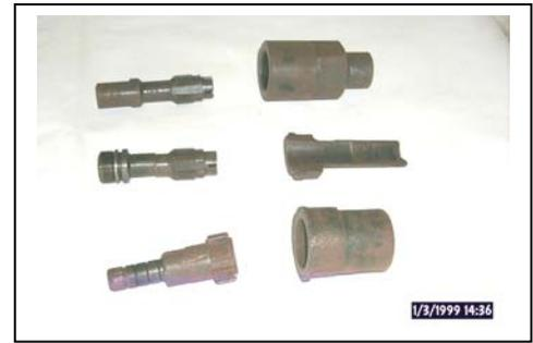
Foto – 10 Boquilla diseñada y construida para el Central Heriberto Duquezne (parte superior) y debajo de ella están los dos modelos que sustituyó.
