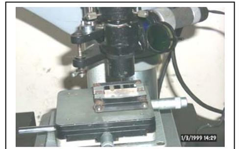
Foto – 22 Montajes de las muestras y probetas para el estudio microestructural de las capas obtenidas.
