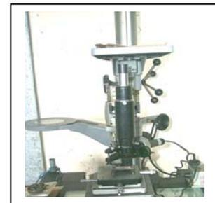
Foto – 24 Instalación para la realización de las fotos microestructurales de las capas carburadas y súper carburadas sobre muestras y probetas.
