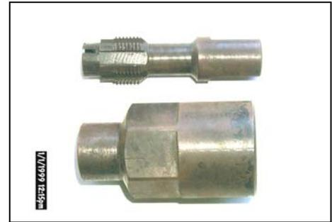
Foto – 6 Boquilla diseñada y construida para el Central Heriberto Duquezne de atomización mecánica para baja presión.
