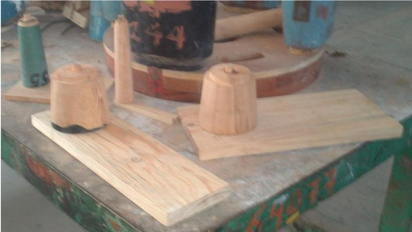
Plantillas de madera de las placas y las mazarotas.
