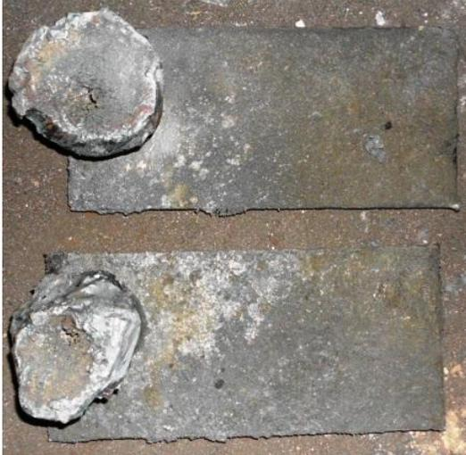
**Figura 33.** Pieza fundida con una relación ancho/espesor igual a 12.
