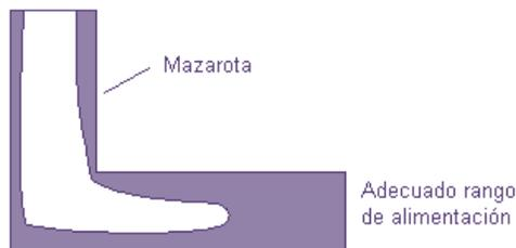
**Figura 9.** Rangos de alimentación para una pieza [4, 6,7].
