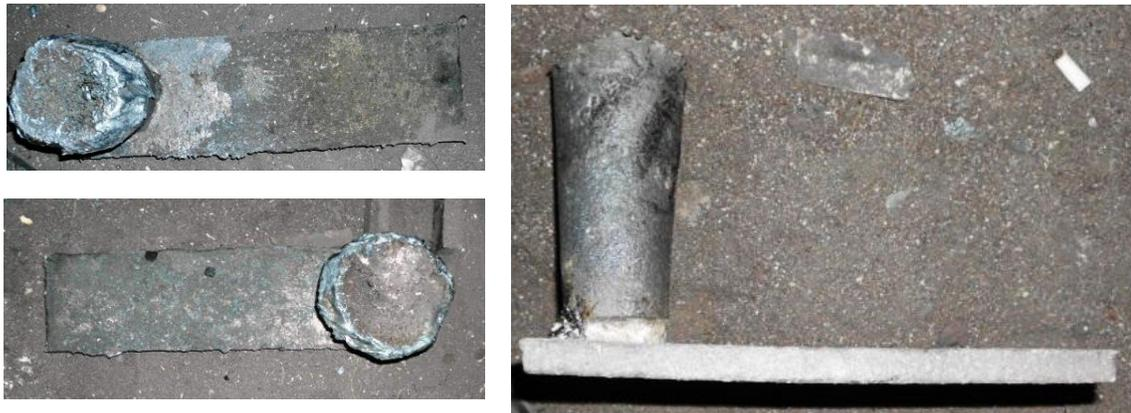
**Figura 32.** Pieza fundida con una relación ancho/espesor igual a 8.
