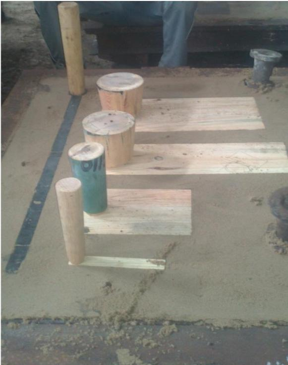
Se colocan las mazarotas en posición para el moldeo.
