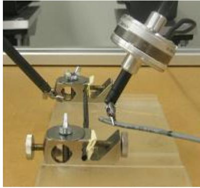
Fig. 41: Instrumento sensorizado para el Da Vinci.
