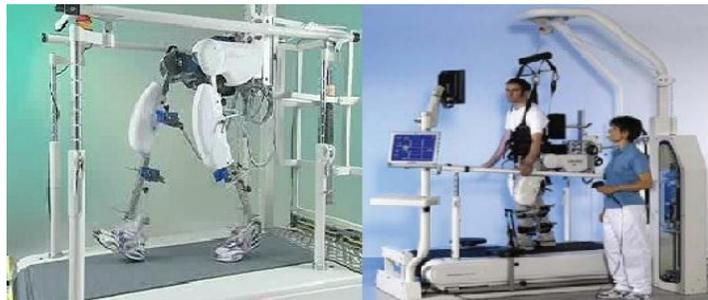
Fig. 19: Sistema robótico Lokomat.
