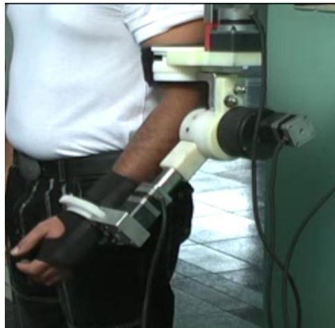
Fig. 53: Prototipo robótico cubano para la rehabilitación del miembro superior.
