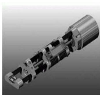
Fig. 45: Ejemplo de Series Elastic Actuator.
