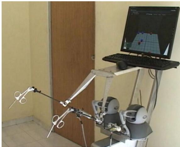
Fig. 50: Simulador virtual para cirugía de mínimo acceso.
