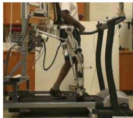
Fig. II.7: Sistema robótico ALEX.
