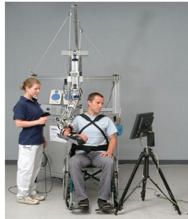
Fig. II.4: Sistema robótico ARMIN para usuarios en silla de ruedas.
