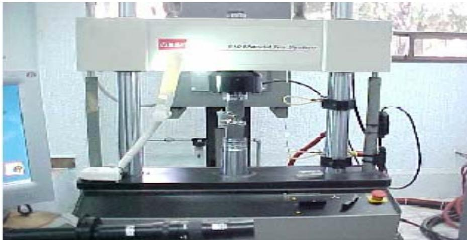
**Figura 2.2** Máquina de fatiga MTS 810 servo-hidráulica del Laboratorio de mecánica experimental del CIDESI.
