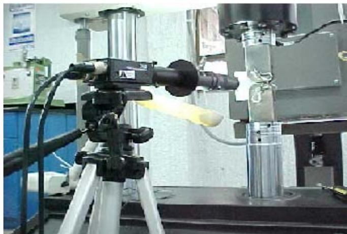
**Figura 2.5** Cámara digital acoplada para obtener una mejor medición
