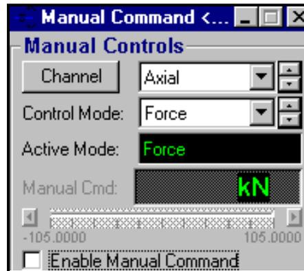
**Figura 2.16** b) Comando manual en el modo de control de fuerza
