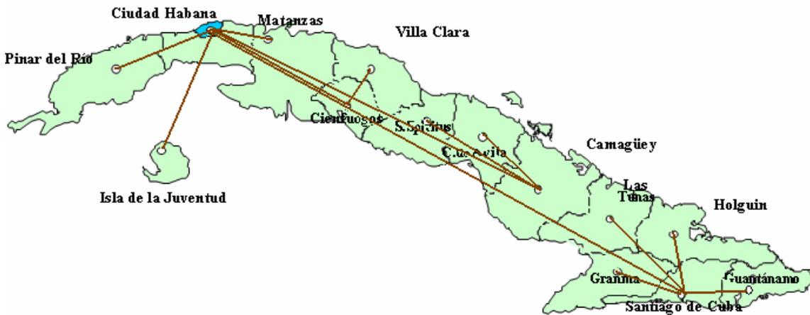
Figura 7 Red de Transmisión (Velocidad de enlaces a 2 Mbit/s con los centros concentradores y de estos a los demás a 128 Kbit/s)
