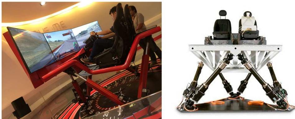
Figura 1-2: Varios tipos de Mesas multiejes para la simulación de vehículos
