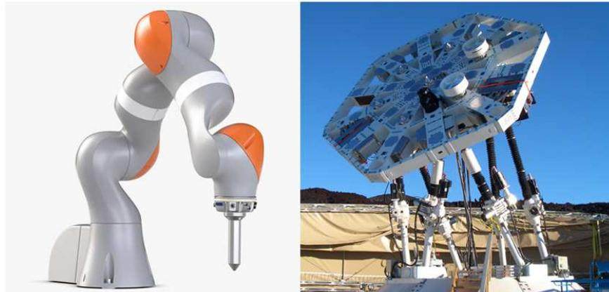
Figura 1-4: Robot serie (izquierda) y paralelo (derecha).
