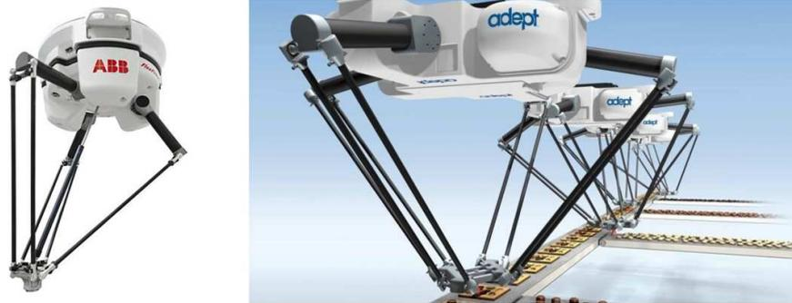
Figura 1–3: Robot Delta presentado por Clavel en aplicaciones de pick and place.
