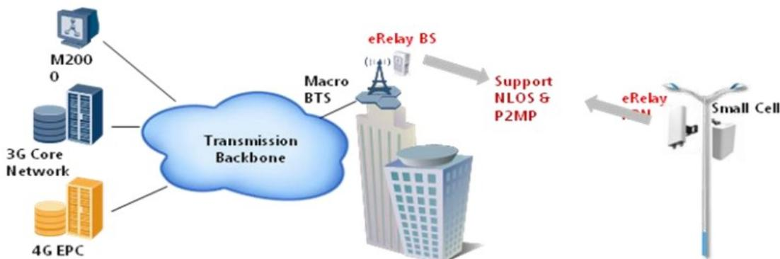
Figura 2.5 Backhaul inalámbrico para la cobertura en exteriores [18]
