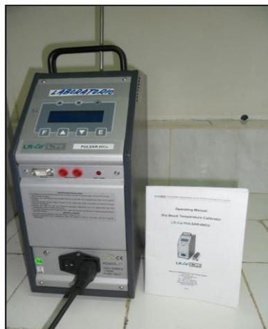
**Figura B-4.3:** Generador resistivo PULSAR-80Cu
