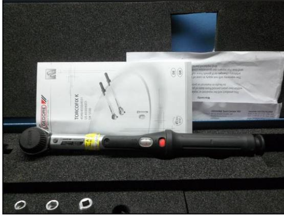
Figura B-2.1: Llave Dinamométrica TORCOFIX-X
