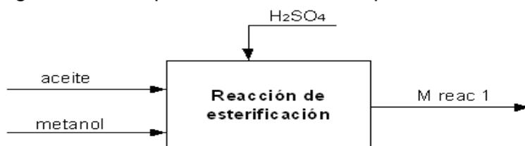
Fig.2.4 Reacción de esterificación del aceite.
