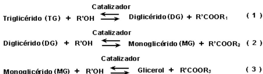
Fig.1.3: Mecanismo de reacción.
