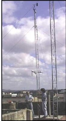
Para la determinación de las variables meteorológicas se emplea una estación meteorológica automática, figura 3.3, que permite crear la base de datos con la información atmosférica, temperatura, presión, velocidad y dirección de los vientos, radiación solar, humedad relativa y precipitaciones. Estas variables juegan un papel fundamental en el transporte y dispersión de los contaminantes.
