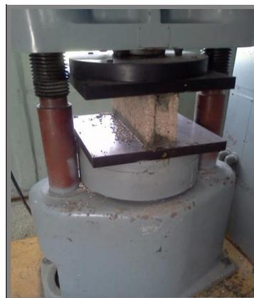
**Figura 2.9: Ensayo de resistencia a la compresión**
