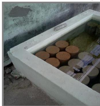
**Figura 2.14: Curado de las probetas de hormigón**
