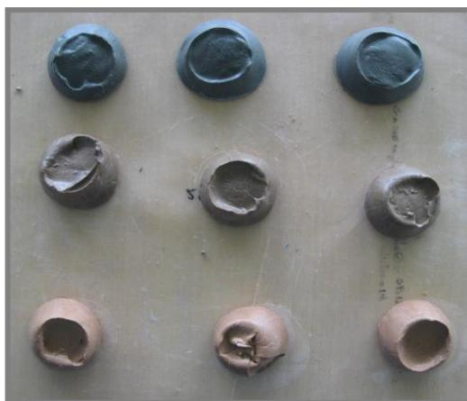
**Figura 2.7: Pastillas de cemento resultantes al levantar el minicono.**
