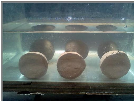
**Figura 2.5: Bolas de cemento sumergidas en agua**
