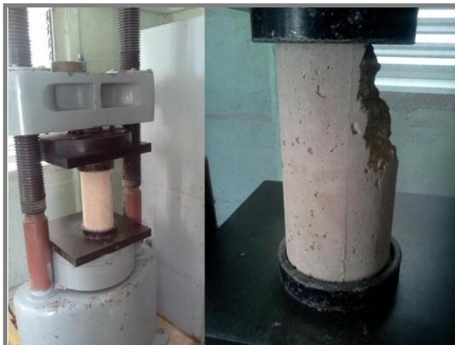
**Figura 3.4: Ensayo de resistencia a la compresión a las probetas de hormigón**
