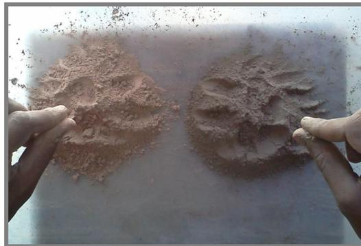
**Figura 2.3: Ensayo Visual-Táctil**
