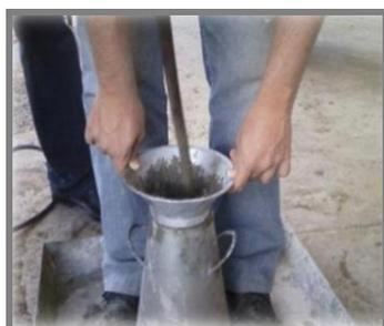
**Figura 2.12: Medición del asentamiento**
