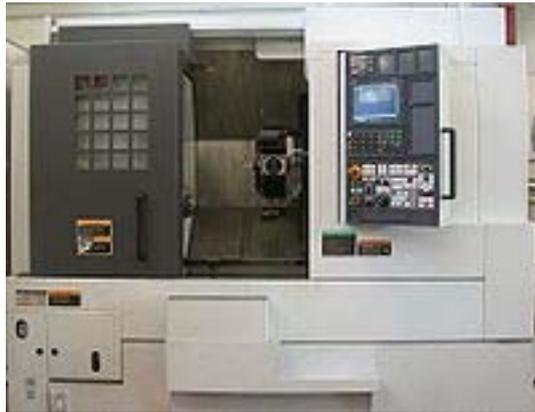
Fig. 1.2: Torno por control numérico. [8]
