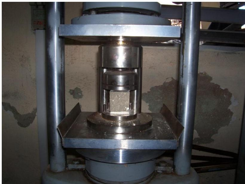
Figura 2.12 Colocación de la probeta en el equipo para el ensayo a compresión.
