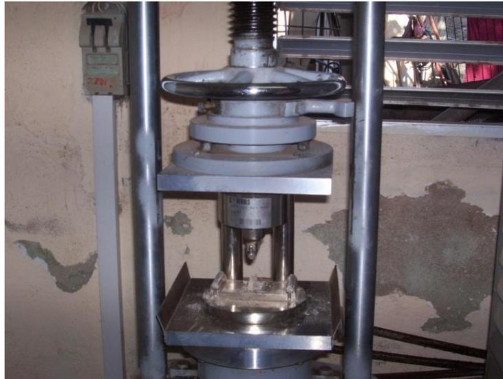
Figura 2.9. Máquina empleada para realizar el ensayo a flexión.
