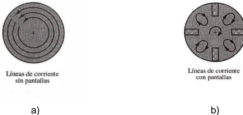
Figura 2.4. Líneas de corriente según la estructura del depósito.
