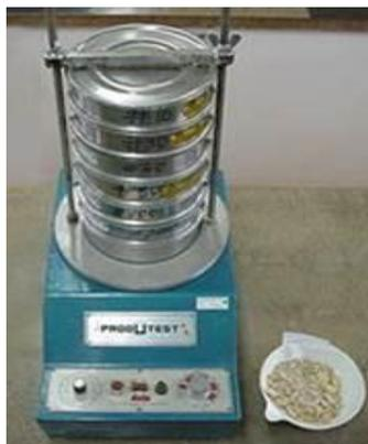
Figura 2.16: Tamizadora para ensayo granulométrico.
