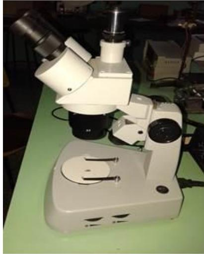
Figura 2.11: Microscopio de bajo aumento.
