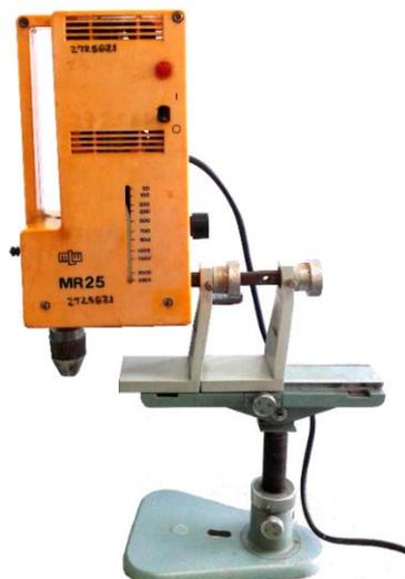
Figura 2.1. Agitador de velocidad variable.
