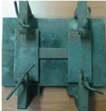
Figura 2.7: Fijación de las chapas para evitar la deformación durante la deposición.
