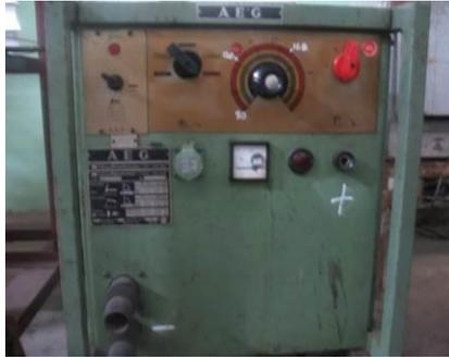
Figura 2.8: Fuente de corriente utilizada en la realización de los depósitos.
