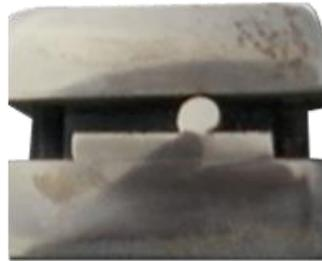
Figura 2.10: Imagen de la muestra montada en el soporte para la preparación metalográfica.
