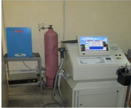
Figura 2.9: Spectrógrafo Belec Vario Lab.
