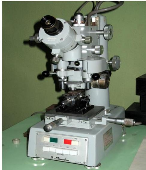
Figura 2.13: Microdurómetro.
