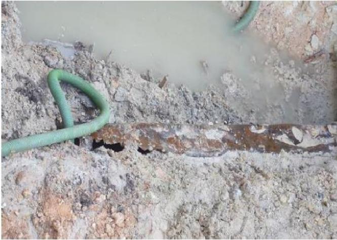
Foto1. Rotura en la tubería de entrada del tanque de la potabilizadora.
