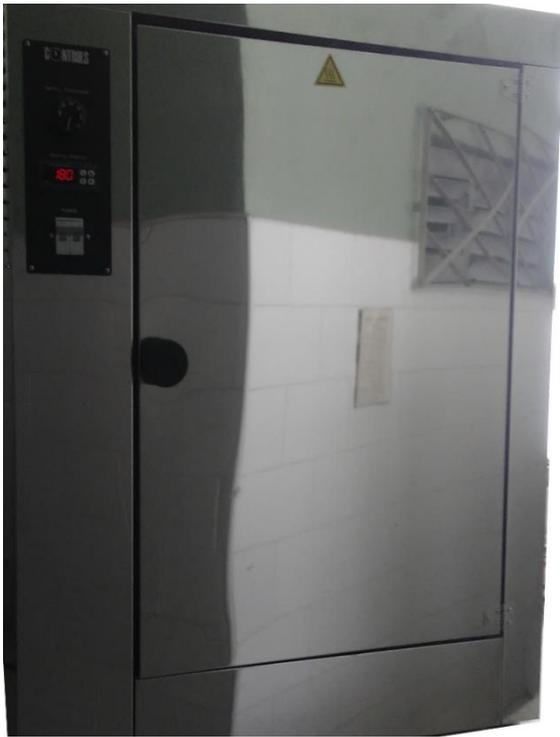
**Figura 2.11:** Estufa CONTROLS usada en el secado de muestras
