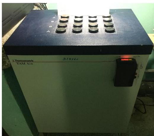
**Figura 2.13** Calorímetro TAM AIR
