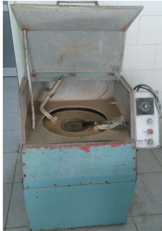
**Figura 2.12:** Molino de anillos usado en la molienda de muestras
