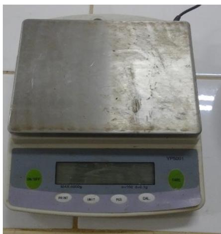
**Figura 2.14:** Balanza YP5001 para el pesaje de los materiales .
