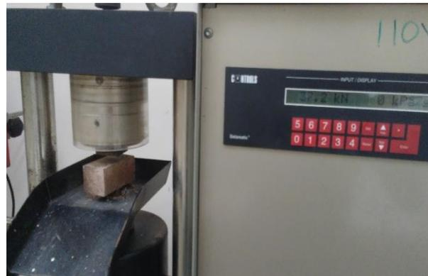
**Figura 2.17:** Prensa usada para ensayos de resistencia a compresión
