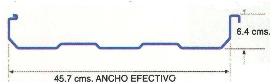
**Fig. 2.1 Perfil MIC SSR 18 (catálogo de MICALUM Cienfuegos).**
