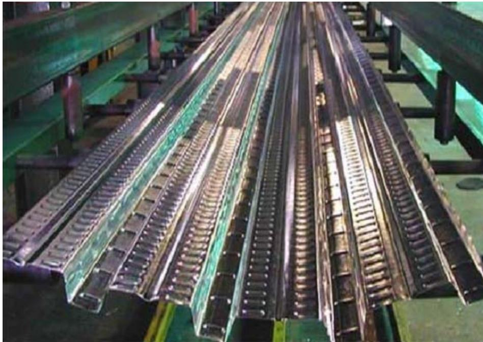
**Fig. 1.6 Láminas con embuticiones de acero para usar en losa compuesta (Bresler B, 1978).**
