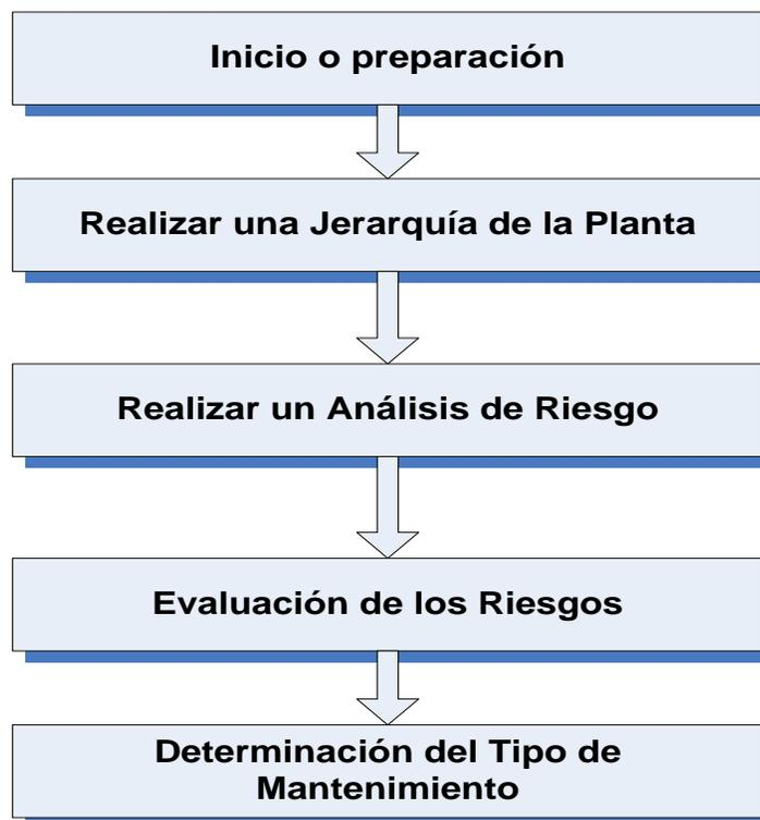
Figura 2.1. Procedimiento general para la selección del tipo de mantenimiento basado en el análisis de riesgos.
