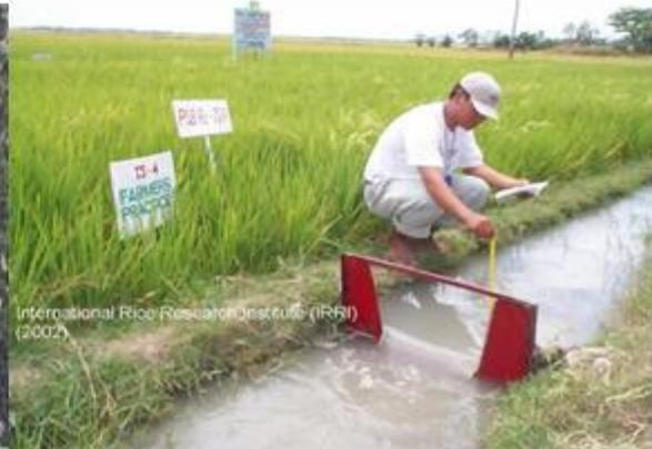
Diferentes tipos de vertederos para medir el agua de riego
