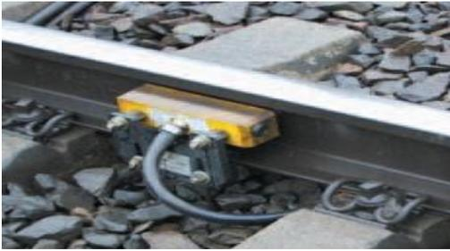
Fig. 1.15 Pedal electrónico FRAUSHER RSR-122
