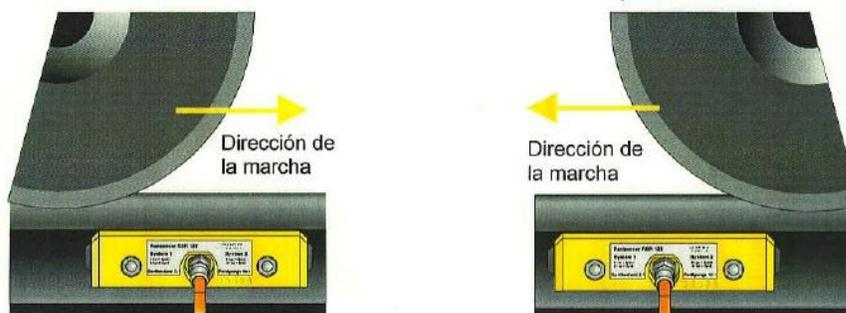
Fig. 2.7 Sensor de rueda FRAUSCHER para detectar el sentido del movimiento
