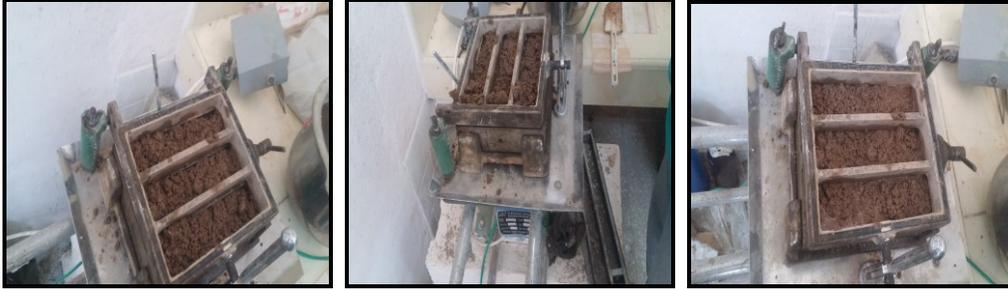
**Figura 2.11.** Elaboración de las probetas utilizadas para los ensayos de resistencia a compresión.
