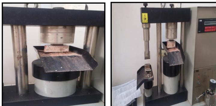
**Figura 3.3.** Ensayo de Resistencia a Compresión.
