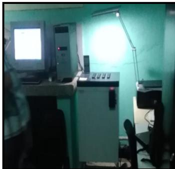
Figura 2.9. Calorímetro isotérmico de la firma Thermometric, TamAir
