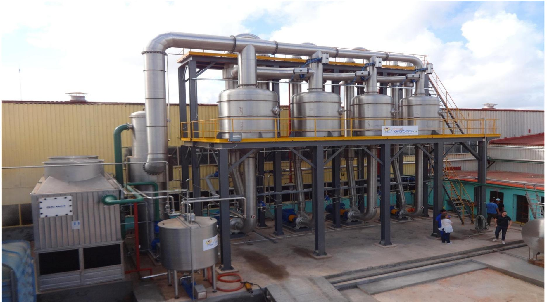
**Figura A.5.** Evaporador de cuádruple efecto con circulación forzada, modelo AN/360.
