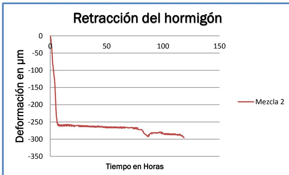
Figura 3.5. Retracción del hormigón en M2.
