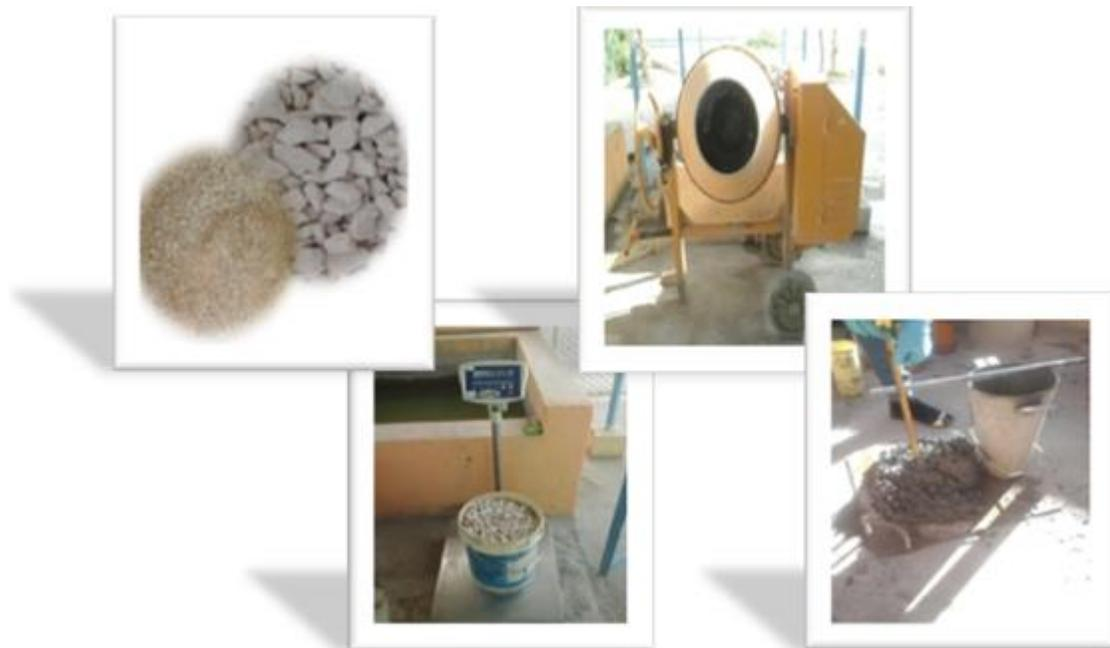
Figura 2.5. Proceso de fabricación del hormigón.
