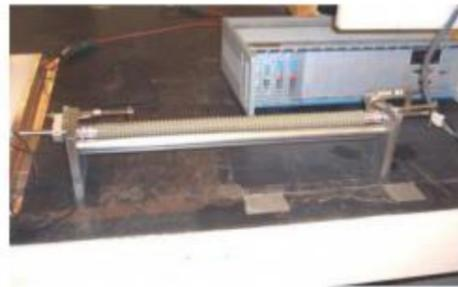
Figura 7: "Método del tubo corrugado"(Thomas et al., 2001).
