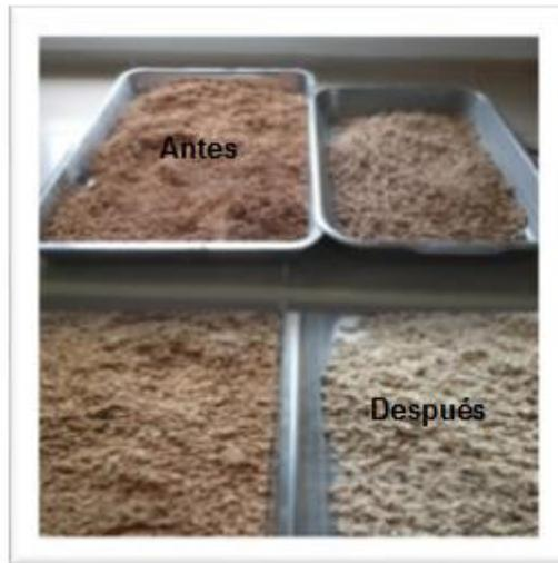
Figura 2.7. Árido fino antes y después de lavado.
