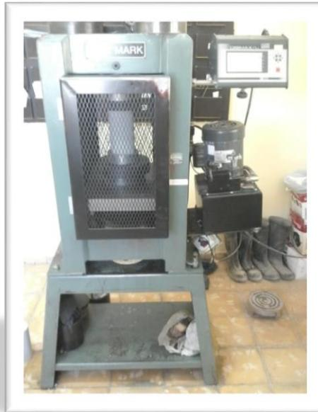
Figura 2.8. Prensa “Test Mark” utilizada en el ensayo de resistencia a compresión.
