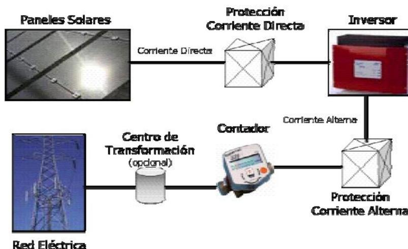
Fig-2.1.1 Esquema general de una instalación solar fotovoltaica con conexión a red. (entorno-BCSD, 2007)
