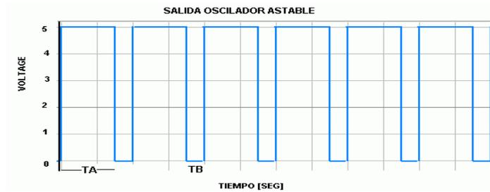
Figura 2.13 Forma de onda del Timer 555 en modo astable
