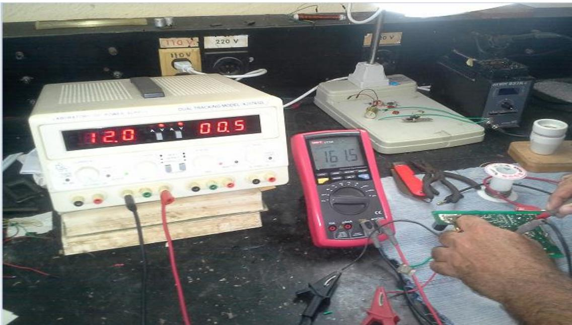
Figura 2.16 Voltaje de Salida en el puente de diodos
