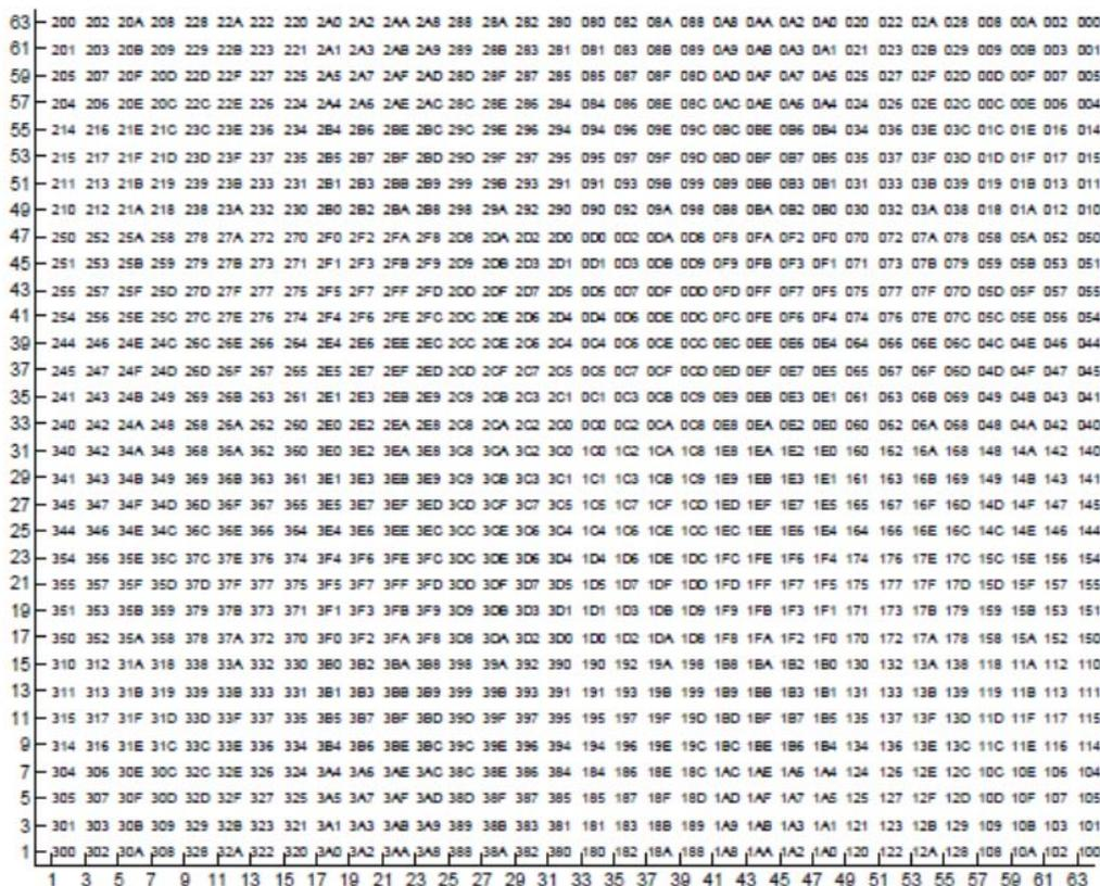
Figura 2.3. Cuadrante 1 de una modulación 4096 QAM [8]
