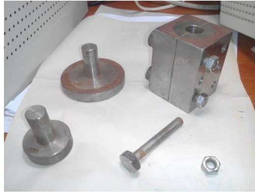
**Imagen 4:** Molde de acero utilizado para la confección de pastillas
