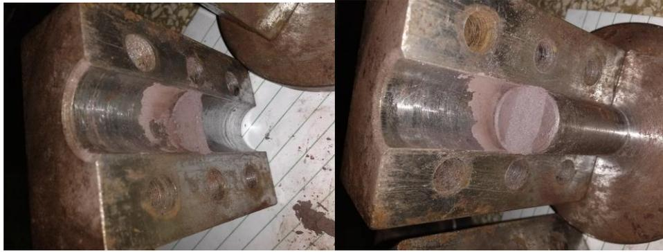
**Imagen 7:** *Fractura de las pastillas con el primer molde usado*
