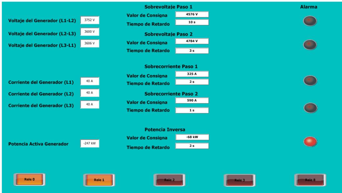
Figura 3.10. Comprobación de la protección de potencia inversa.
