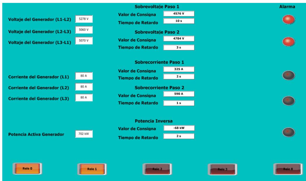
Figura 3.7. Comprobación de la protección de sobrevoltaje paso dos.
