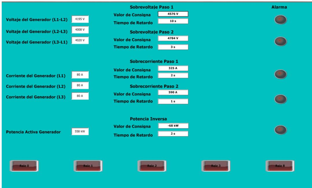
Figura 3.5. Captura de la Pantalla de Protecciones con los valores medidos por debajo de los valores consigna de cada protección.
