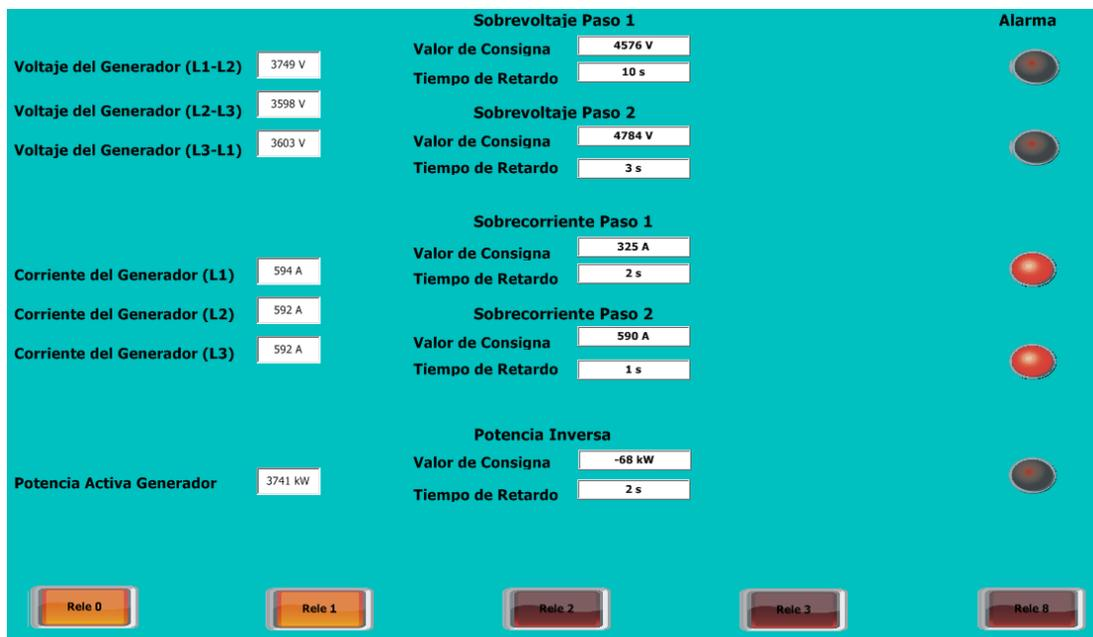
Figura 3.9. Comprobación de la protección de sobrecorriente paso dos.
