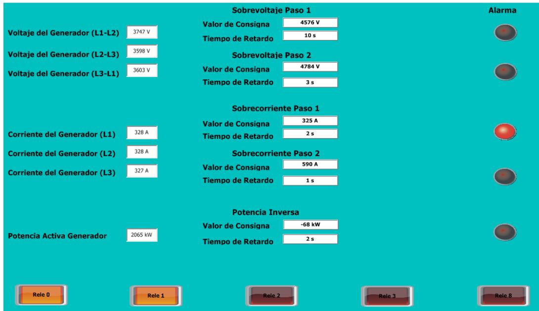
Figura 3.8. Comprobación de la protección de sobrecorriente paso uno.
