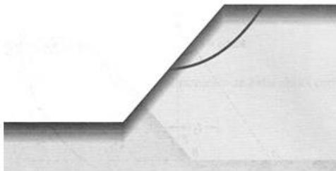
Figura 2.2 Falla superficial de un talud
