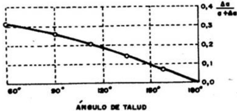
Figura 2.18 Corrección por Casagrande
