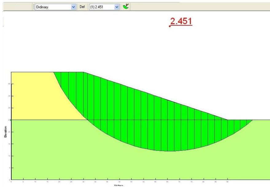
Figura 3.24 Factor de seguridad para el centro critico ( $O_1$ ) y  $R_m$
