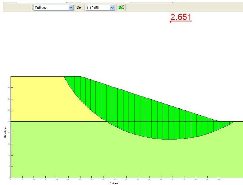
Figura 3.26 Factor de seguridad para el centro crítico (O<sub>3</sub>) y R<sub>m</sub>
