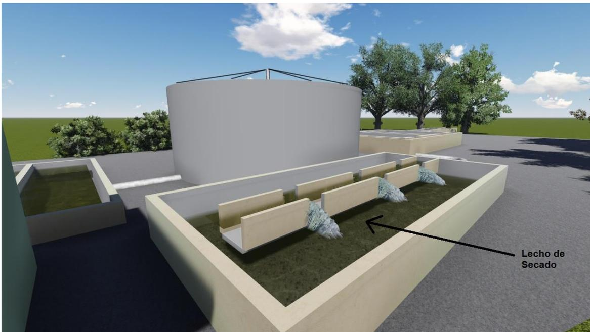
Figura 3.3 Vista en 3D del Lecho de Secado
