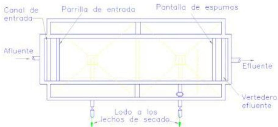
Figura 2.14 Vista en planta del Tanque Imhoff
