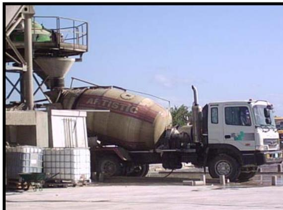
**Figura 2.3.** Camión hormigonera.
