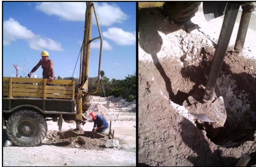
**Figura 2.2.** Camión Barrenador.
