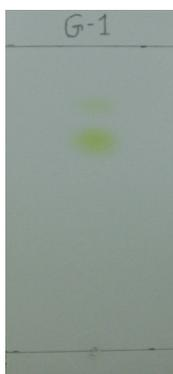
Figura 6: Cromatograma de G-1 (acetonitrilo / agua 50:50, 1000 mg/L); fase móvil tetracloruro de carbono / cloroformo (10:1).
