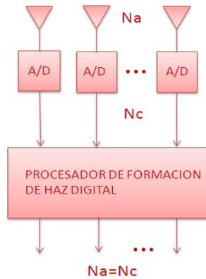
Figura 2.1 Posible arquitectura RF de Conformación de haz digital
