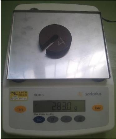
Fig.3.2. Verificación de las pesas utilizadas.
