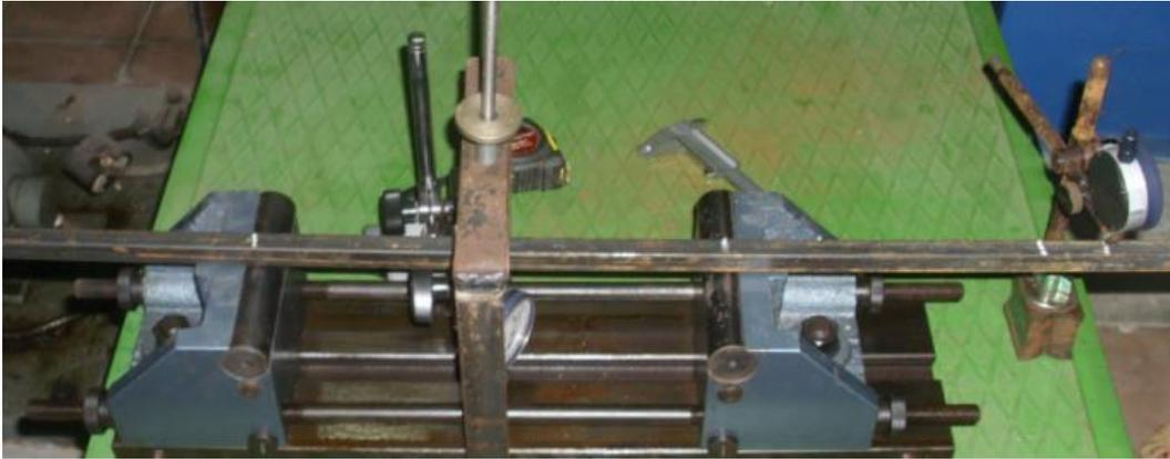
Fig.3.1. Instalación para hacer el ensayo de flexión.
