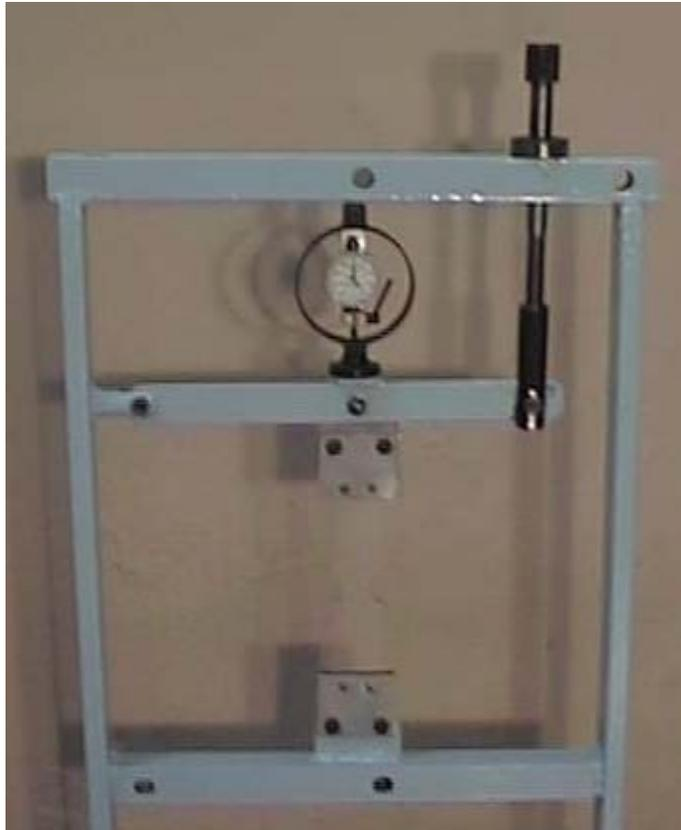
**Fig. 2.8. Montaje del dinamómetro.**
