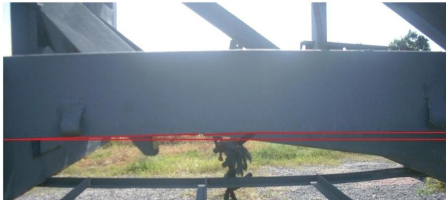
Figura 2.3. Vista lateral del elemento deformado
