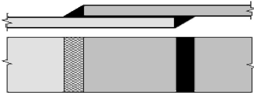
Figura 2.12 Soldadura realizada a filete
