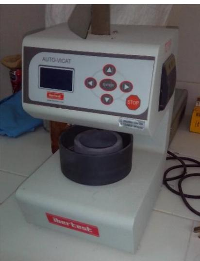
**Figura 2.4** *Ensayo de Consistencia normal y Aguja de Vicat*
