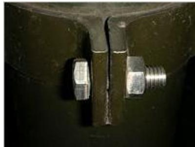
Figura 8. Corrosión de tornillo con otro metal, expuestos ambos a la humedad ambiental.
