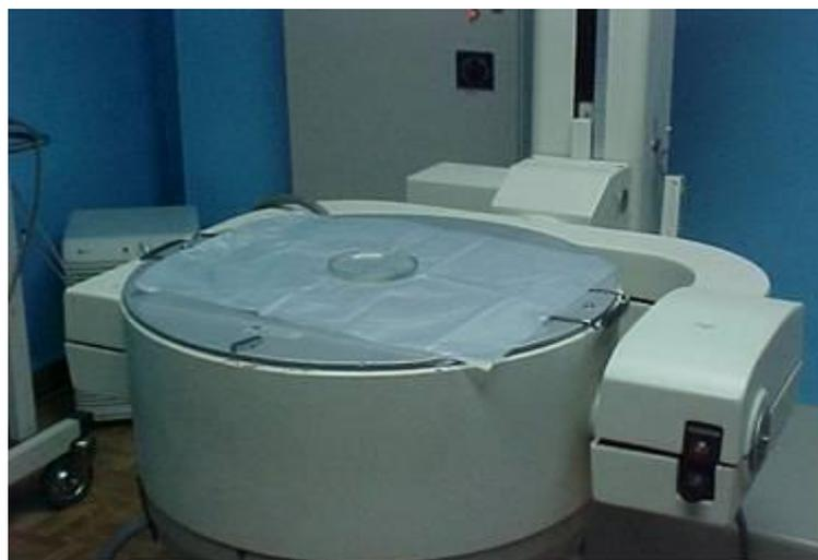
**Figura 9.** Geometría para la medición de la sensibilidad plana del sistema.
