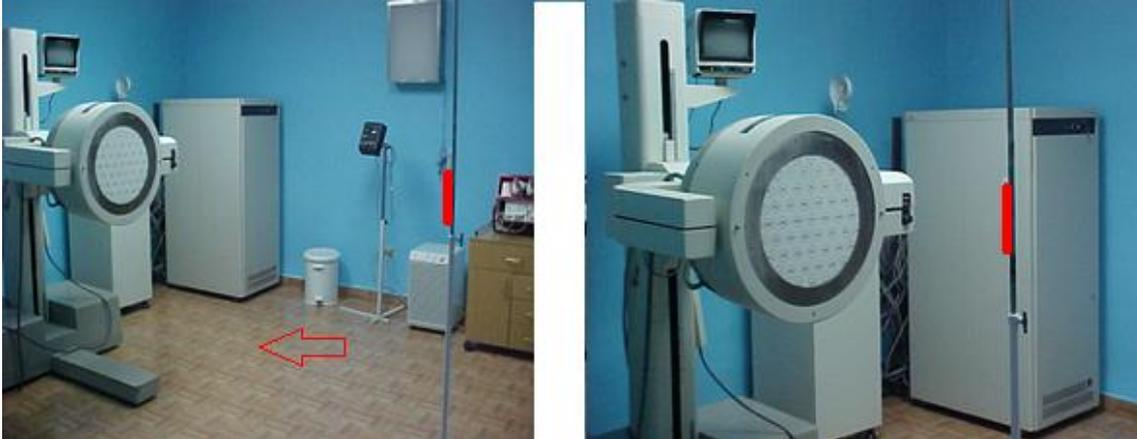
**Figura 8.** Procedimiento para la determinación de la tasa máxima de conteos (notar que el soporte móvil se acerca paulatinamente hacia el detector).
