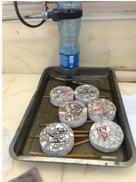
**Figura 2.9 Esquema de bandejas con el ensayo de absorción y la probeta invertida para garantizar una altura constante de agua en la bandeja**
