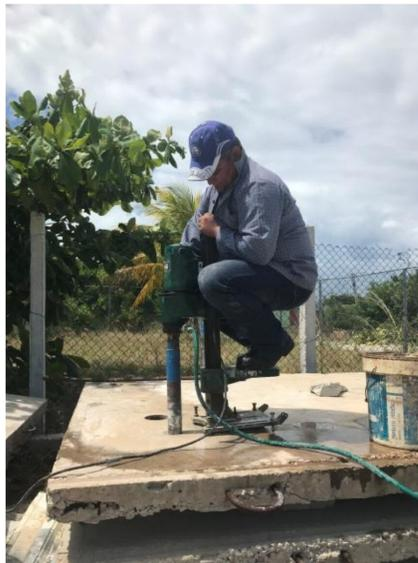
**Figura 2.4 Equipo usado para la extracción de testigos. (Foto tomada por el autor)**
