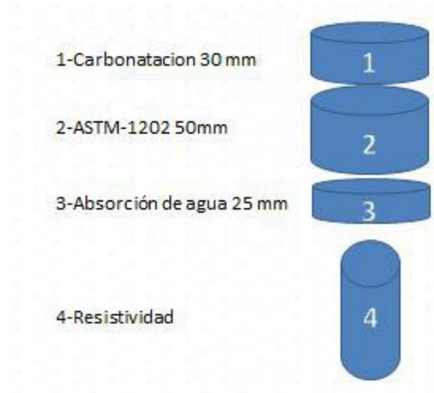
**Figura 2.5 Cortes realizados a los testigos de hormigón.**
