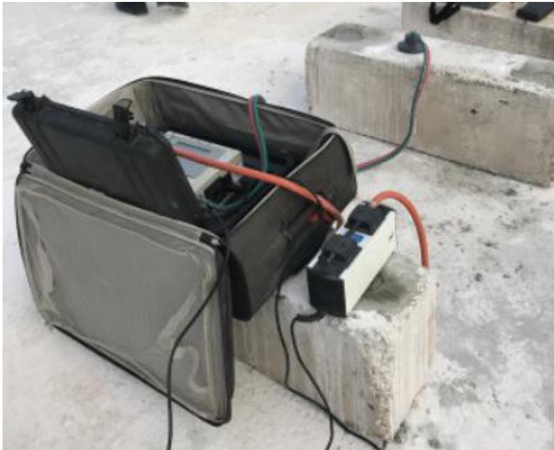
**Fig. 2.6 Permea-TORR, equipo utilizado para medir la permeabilidad al aire (foto tomada por el autor)**
