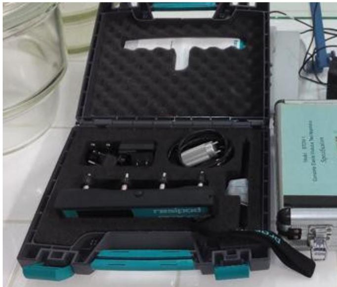
**Fig. 2.7 Resipod, equipo utilizado para medir la resistividad eléctrica (foto tomada por el autor)**
