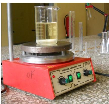
Figura 9. Agitador magnético
