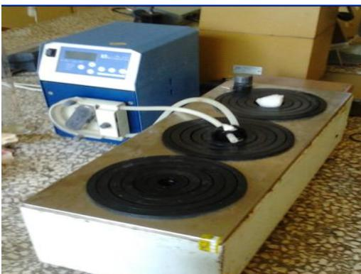
Figura 6. Baño de agua y bomba peristáltica.
