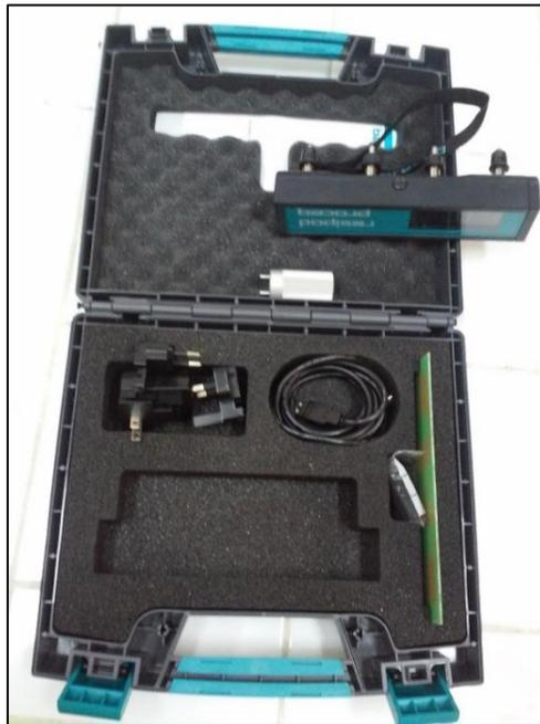
*Fig. 1.6: Resipod Proceq (Tomada por el autor)*
