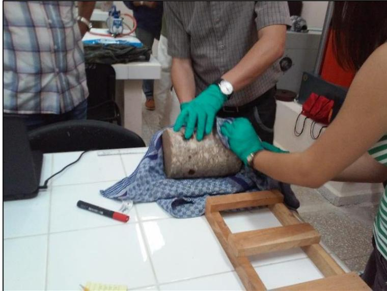
*Fig. 2.5: Secado de los testigos (Tomada por el autor)*
