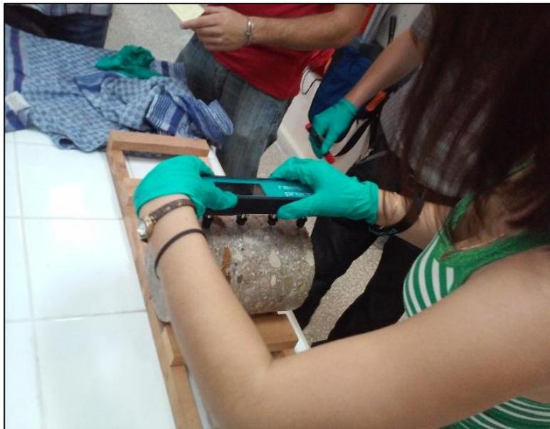
*Fig. 2.6: Medición de la resistividad eléctrica superficial (Tomada por el autor)*
