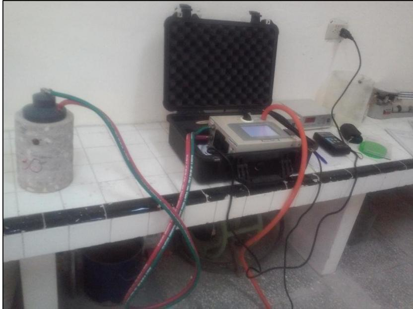
*Fig. 2.4: Medición de la permeabilidad al aire (Tomada por el autor)*
