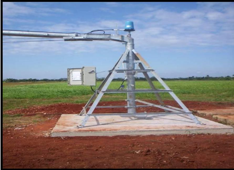
**Figura No.8:** Entrada de agua y energía al pivote. Panel de control
