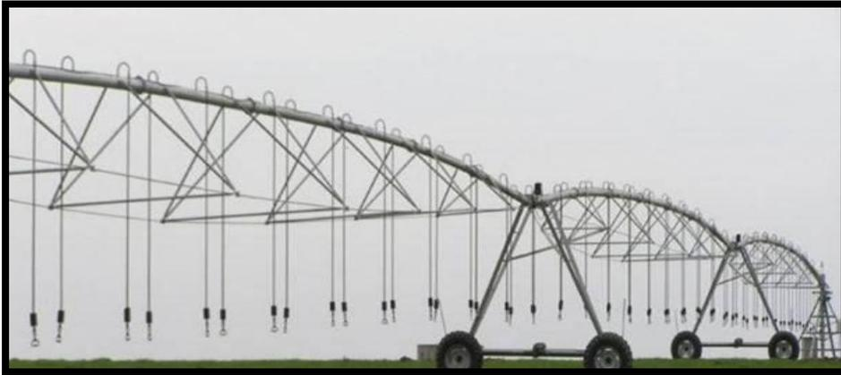
**Figura No.9:** Tubería Lateral de una máquina de pivote central
