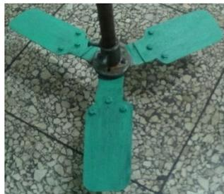
**Figura 3.1** Dispositivo porta-hélice
