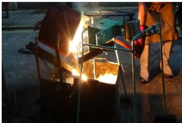
**Figura 3.3** Proceso de fundición de la carga I
