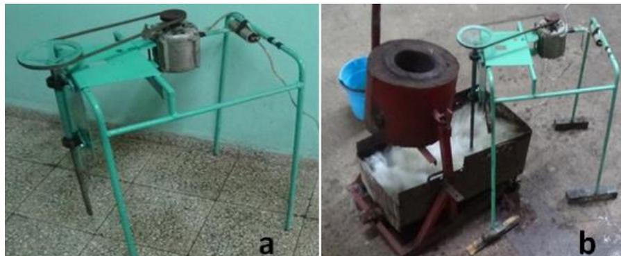
**Figura 3.2 a)** Conjunto del Agitador mecánico ensamblado y **b)** Agitador mecánico con horno de grafito y recipiente de fondo cóncavo en funcionamiento.
