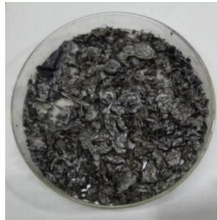
**Figura 3.4** Metal vertido y granulado de la Primera colada
