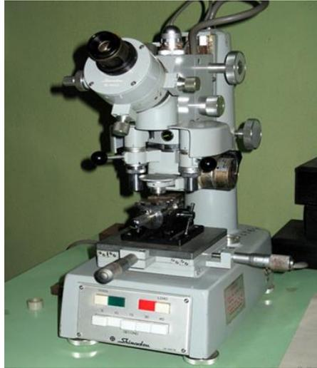
Figura 2.3 Microdurometro empleado
