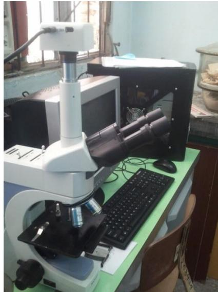
Figura 2.2 Microscopio metalográfico
