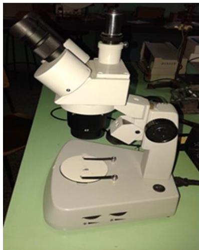
Figura 2.1 Microscopio de bajo aumento
