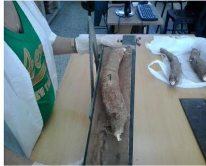
Fig. 2.6 Cuerpo libre y aparato para la determinación del coeficiente de fricción. Fuente: Archivo del autor.
