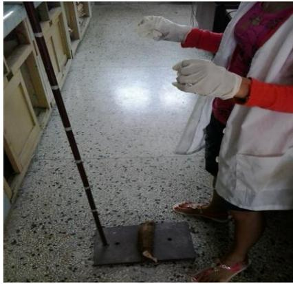
Fig. 2.10. Instrumento utilizado para la caída libre. Fuente: Archivo del autor.
