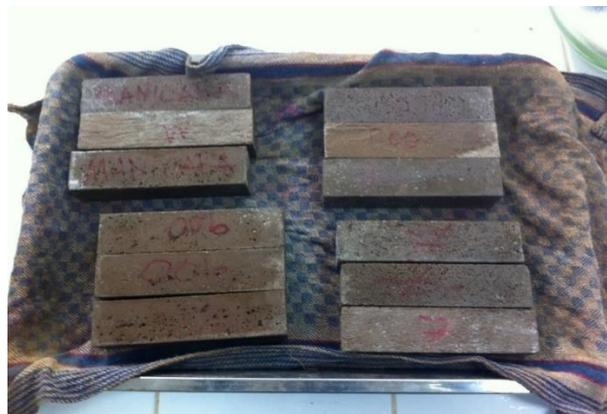
Fig.2.9 Probetas prismáticas 40 x 40 x 160 mm. Fuente: Elaboración propia.
