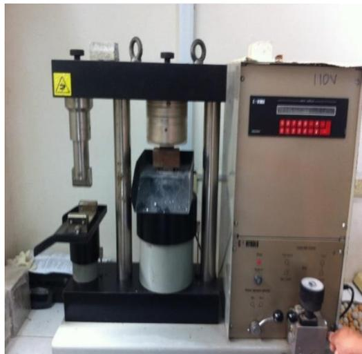
Fig. 2.17 Máquina de ensayo de resistencias a compresión
