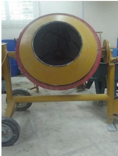
Fig.2.18 Hormigonera de eje vertical. Fuente: Elaboración propia.
