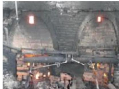
Fig.2.8 Disposición de los quemadores
