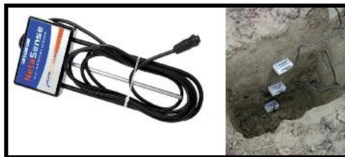
*Figura 2.9 Sensor de humedad NetaSense*
