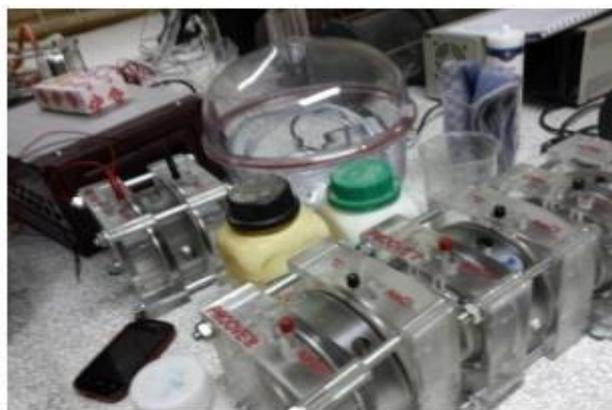
**Figura 1.3.2 Equipo para la penetración de cloruros.**
