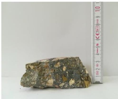
**Fig. 3.4. Ensayo de perfil visual de cloruro.(ARE 2016 Punta Matamoros).**
