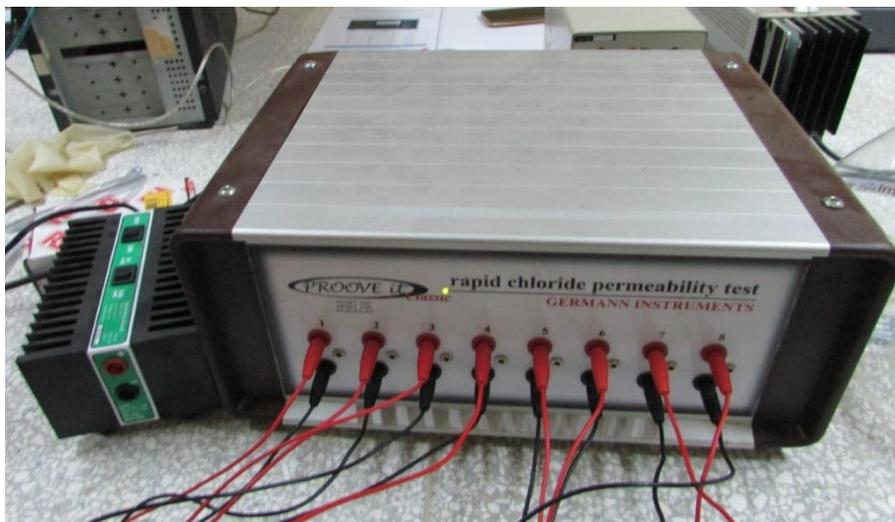
**Fig. 2.7 Unidad de verificación PR-1055(izq.) y unidad de poder PROOVE'it (der.)**
