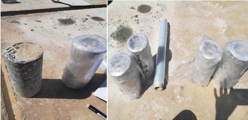
**Fig. 2.3. Retractilado de especímenes.**
