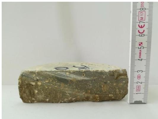
Fig. 3.4.2. Ensayo de perfil visual de cloruro.(ARE 2016 Facultad de Construcciones).
