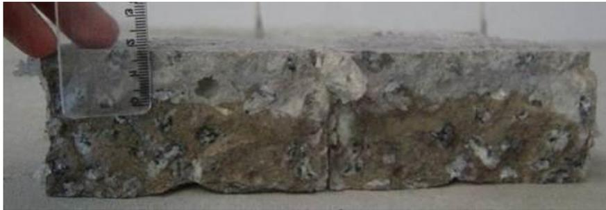
**Figura 1.3.4. Ensayo de Nitrato de Plata.**
