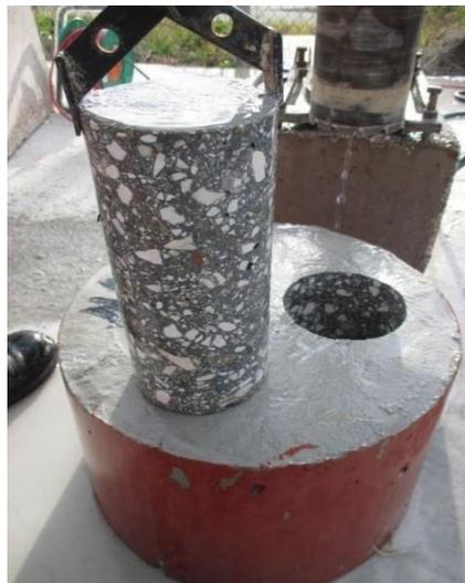
**Fig.2.4.extracción de especímenes.**
