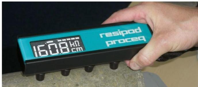
**Figura 1.3.2. Equipo para medir Resistividad Superficial.**
